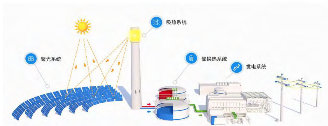
图 2 熔融盐塔式太阳能热发电系统示意图（图片来源：可胜技术）
